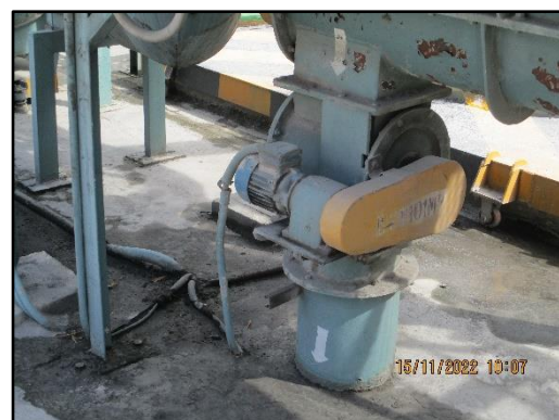
ภาพที่ 2.33 ของเสียจาก Bag Filter ที่นำกลับมาใช้ในกระบวนการผลิต
